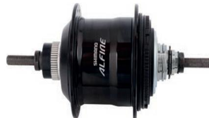
Sie ist so leicht wie die 8 Gang Alfine Nabe. Die 11 Gang Alfine ist sehr fein und gleichmäßig abgestuft, so steht Ihnen immer der richtige Gang zur Verfügung. Bei unseren Rädern wird die 11 Gang Nabe mit einem Ritzel von 21 Zähnen und einer Kettenradgarnitur mit 38 Zähnen ausgestattet
