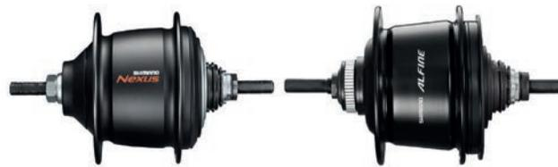
Die 8 Gang Shimano Nabenschaltung ist als Nexus Freilauf- oder Rücktrittversion, sowie als Alfine Freilauf erhältlich. Auch hier ist das innere Übersetzungsverhältnis der Schaltung identisch. Bei dieser Schaltung haben wir ein Kettenblatt mit 38 Zähnen und ein Kettenritzel mit 19 Zähnen gewählt.
