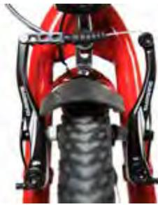
Die Shimano V-Bremse ist die leichte Alternative zu der hydraulischen Felgenbremse. Sie gewährleistet eine hohe Bremsleistung sowohl bei Trockenheit als auch bei Nässe. (Gewicht: ca. 410 Gramm/Pair inkl. Bremshebel und Züge).
