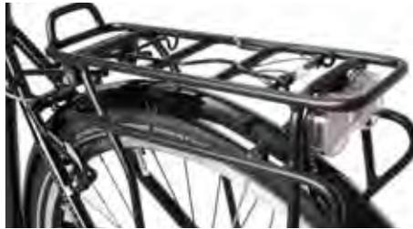
Mit großer Ladefläche ist er optimal geeignet für Touren. Die tiefe Packtaschenanbringung ermöglicht eine verbesserte Schwerpunktlage des Gepäcks. Durch ihre Positionierung weit hinten ergibt sich große Fußfreiheit. Das Rücklicht ist besonders geschützt. Er ist bis zu 25 kg belastbar. (Gewicht: ca. 865 Gramm)
