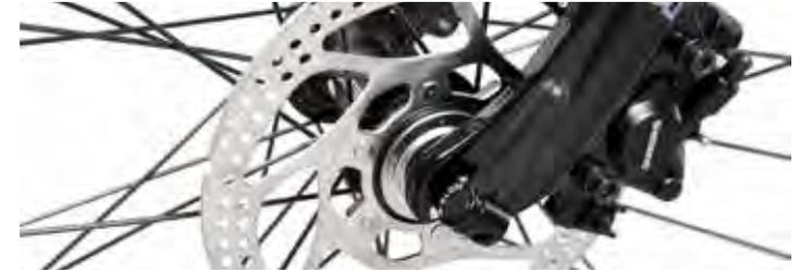
Bei Trockenheit oder Nässe packt die Scheibenbremse immer kräftig zu. Die hohen Bremswerte sind unter anderem auf das verbaute Hydrauliksystem zurückzuführen. Ein weiterer Vorteil der Scheibenbremse ist die konstruktionsbedingte Vermeidung von Felgenverschleiß, da die Verzögerung wie bei einem Motorrad über Bremsklötze und Bremsscheibe erfolgt.
