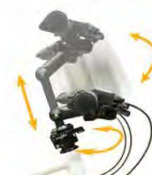
Dieser leichte Ahead Vorbau ist äußerst variabel einstellbar. Nicht nur im Neigungswinkel, sondern auch in der Höhe (100 mm) lässt sich dieser Vorbau werkzeugfrei einstellen. Mit Verriegelungsbolzen und Schnellspannhebel können Sie den Twist Pro Speedlifter um 90° drehen, so dass Sie Ihr Fahrrad leicht und platzsparend unterbringen können. Er ist zusätzlich mit einem Auszugsstopp mit Diebstahlsicherung ausgestattet. (Gewicht: ca. 370 Gramm)
