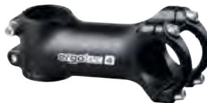
Der Ahead Crab 2 ist ein ultra leichter 3D-geschmiedeter Aluminium-Ahead-Vorbau mit 4-Schrauben-Lenker-Klemmung, 7° Winkel und 31,8 mm Lenkerbügel-Klemm-Durchmesser. Die Klemmhöhe beträgt 41 mm. (Gewicht: ca. 148 Gramm)
