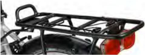
Dank großer Ladefläche, Federklappe und Gurtaufnahme ist der Gepäckträger VDV Aluminium optimal geeignet zur Anbringung von Einkaufskörben und Packtaschen. Er ist bis zu 25 kg belastbar. (Gewicht: ca. 625 Gramm)
