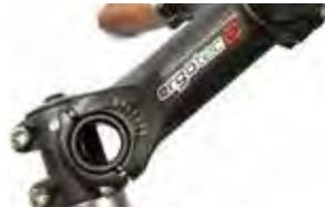
Der leichte, 3D geschmiedete Swell R Vorbau aus Aluminium ist sowohl winkel- als auch höhenverstellbar. Bei der Höhenverstellung verhelfen Raster und vier Klemmschrauben zu einem sicheren Halt. Die Winkelverstellung liegt in einem Bereich von -20° bis +40°. (Gewicht: ca. 280 Gramm)
