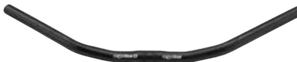
Mit 16 mm Erhöhung und einem 30° Griff-Winkel vermittelt dieser sehr leichte Lenkerbügel aus Aluminium eine sportliche und entspannte Sitzposition. Als Oversize wird er mit einem Durchmesser von 31,8 mm eingesetzt. (Gewicht: ca. 292 Gramm)
