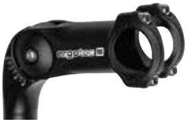
Dieser stabile, hochwertige, 3D-geschmiedete Aluminium-Schaftvorbau ist durch eine 4-Schrauben-Lenker-Klemme gesichert. Der Vorbau ist im Neigungswinkel einstellbar. (Gewicht: ca. 440 Gramm)
