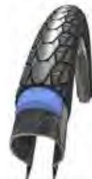
Durch seinen neu entwickelten Pannenschutzgürtel schützt der Marathon Plus sehr effektiv vor Schlauchdefekten. Die Einlage aus hochelastischem Spezialkautschuk SmartGuard bietet auch eingefahrenen Fremdkörpern wie Scherben oder Granulat dauerhaft Paroli. (Gewicht: ca. 960 Gramm / 40-622)
