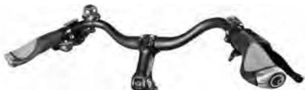
Mit 38° Griff-Winkel vermittelt der Genuss- und Komfortlenker eine deutlich aufrechtere Sitzposition als die Trekking-Lenkertypen. Er sorgt für guten Überblick im Stadtverkehr. Als Oversize wird er mit einem Durchmesser von 31,8 mm eingesetzt. (Gewicht: ca. 328 Gramm)
