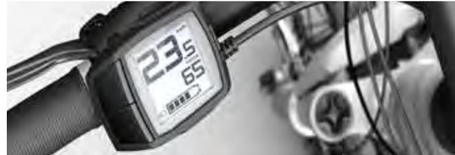
Purion ist der minimalistische Bordcomputer für alle, die sich auf die wichtigsten Informationen konzentrieren und am Fahrradlenker eine aufgeräumte Optik wünschen. Während der Fahrt bedienen Sie Purion direkt und bequem mit dem Daumen, die Hand bleibt am Lenker. Fünf verschiedene Fahrmodi geben Ihnen in jeder Situation die individuell richtige Unterstützung.
