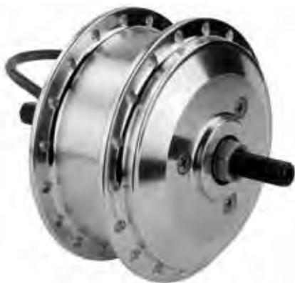
Der bürstenlose Gleichstrommotor wird mit 36 Volt angetrieben und bringt eine Leistung von 250 Watt. Das maximale Drehmoment beträgt 25 Nm. (Gewicht: ca. 2,6 kg)
