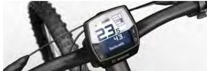
Das abnehmbare Display lässt sich über nur 3 Tasten steuern. Geschwindigkeit, Durchschnittsgeschwindigkeit, Gesamtkilometer, Tageskilometer und Restreichweite des Akkus sind gut ablesbar. Fahrmodus und das gewünschte Unterstützungslevel können selbst erklärend eingestellt werden.
