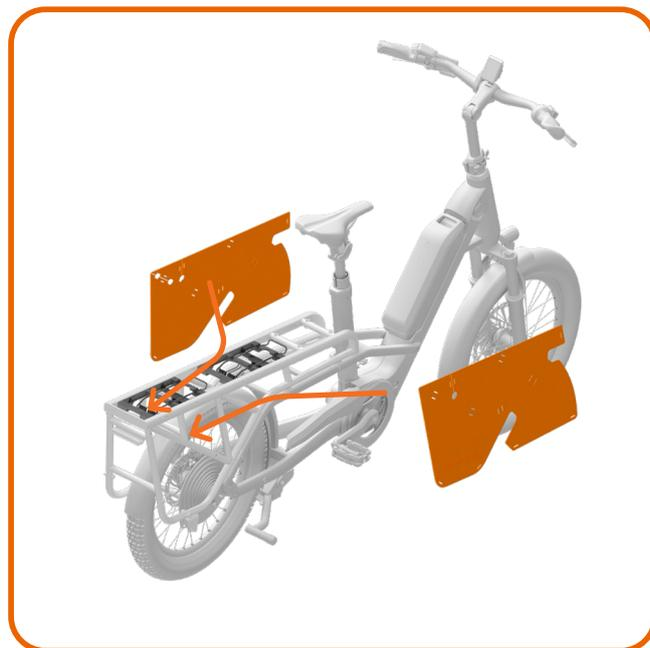
Die Wheel-Covers werden von vorne nach hinten zwischen Radschützer des Hinterrades und den Gepäckträgerstreben in die passende Position geschoben. Orientieren Sie sich dabei an den Löchern für die Befestigung in den Wheel Covern (siehe Grafik auf Seite 31).
