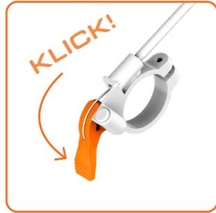
Drücken Sie zum Entsperrn der zweibeinigen Parkstütze den Entsperrhebel am Cockpit bis Sie ein Einrasten spüren und einen Klick hören.
