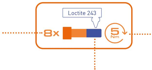
Trotz selbst sichernden Muttern empfehlen wir die mitgelieferten Schrauben mit flüssigen Schraubensicherungen zu versehen, wie Loctite 243.
