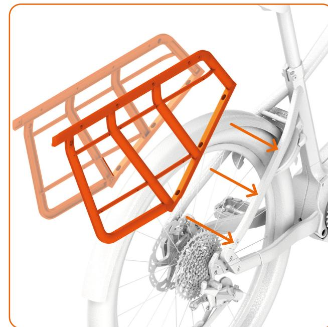
Wenn Sie den SEB PRO HD-CARRIER nachrüsten möchten, müssen Sie ggf. den regulären SEB Rear Carrier demontieren. Dafür lösen Sie die sechs Schrauben an den Sattelstreben. Zudem müssen Sie die Energieversorgung zum Rücklicht trennen.
