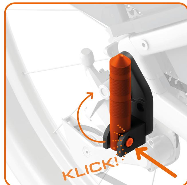
Sobald die Fußrasten mit den Adapterplatten montiert sind, können Sie diese am Ausfallende montieren. Demontieren Sie dafür die alten Schrauben und montieren Sie anschließend die Fußrasten und Adapter mit den beiliegenden Schrauben. Achten Sie auf die passende Riemenspannung falls Sie einen Riemenantrieb nutzen.
