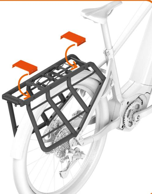
Die zwei Top-Covers werden vor und hinter dem Deck installiert. Dafür werden diese in Position geschwenkt und anschließend an den vorgesehenen Stellen verschraubt.
