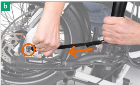
**[b]** Halten Sie mit einer Hand die Lenksäule und damit den Lenker auf Abstand zum Befestigungspunkt unten an der Vorderradgabel.
