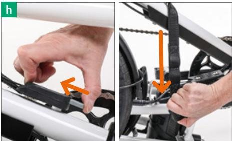
**[i]** Rasten Sie die Schließe des Befestigungsriemens am Haltepunkt ein und lassen Sie die Taste los.
