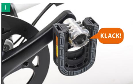
**[i]** Klappen Sie dann das Pedal um 90 Grad nach unten oder oben, bis das Pedal hörbar einrastet. Das Pedal pendelt selbstdäig aus.
