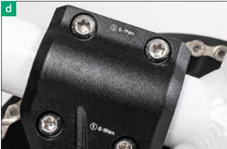
8. Prüfen Sie alle **Anbau- und Zubehörteile**, wie bspw. den Heck-Gepäckträger etc., indem Sie versuchen, die Teile behutsam hin und her zu bewegen, um deren festen Sitz zu überprüfen. Sollten Bauteile nicht richtig fest sein, richten Sie ggf. die Bauteile neu aus und drehen Sie die Schrauben vorsichtig fest, bis die Bauteile sicher klemmen. Wenn Sie sich nicht absolut sicher sind oder Fragen haben, wenden Sie sich an Ihren VELO DE VILLE-Fachhändler.
