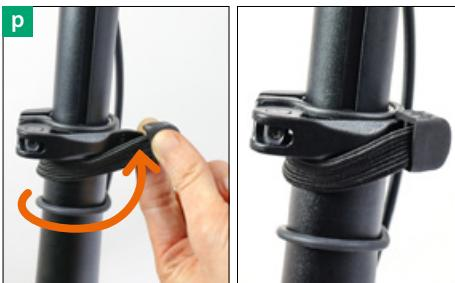
**n** Stellen Sie jetzt Ihr FOLDY auf Vorder- und Hinterrad ab. Rasten Sie jetzt den Sperrbolzen ein. Lassen Sie ihn anschließend los und prüfen Sie, ob er vollständig und korrekt eingerastet ist.
