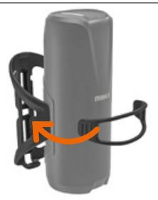
**[g]** Befestigen Sie zur Sicherung des Akkus die Gu-milasche an den seitlichen Halterungen.
