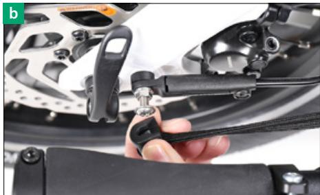
**[a+b]** Halten Sie mit einer Hand die Lenksäule und damit den Lenker auf Abstand zum Befestigungspunkt unten an der Vorderradgabel. Greifen Sie mit der anderen Hand das Gummiband und hängen Sie das Ende aus dem Befestigungspunkt an der Gabel aus.
