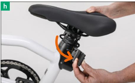
**[h]** Öffnen Sie den Sattelstützen-Klemmhebel am Rahmen.
