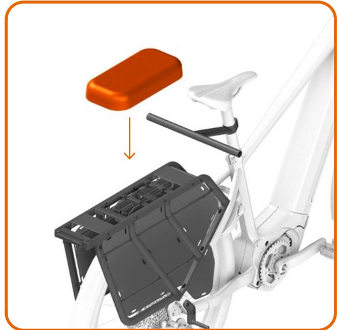
Klicken Sie dafür das Seat-Pad auf das mittlere Deck. Beachten Sie, dass die Verwendung von zwei Decks unzulässig für den Personentransport ist! Außerdem muss das Seat-Pad mittig am SEB PRO HD-CARRIER montiert werden!
