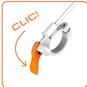
Per sbloccare il cavalletto centrale a due gambe, premere la leva di sblocco sul cockpit finché non si avverte l'innesto e si sente un clic.
