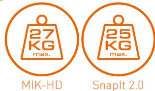
A seconda delle esigenze, i deck del portapacchi possono essere equipaggiati con il sistema MIK-HD o Racktime Snapit 2.0. Con il sistema MIK-HD è possibile caricare 27 kg. Con il sistema Snapit 2.0 25 kg.
