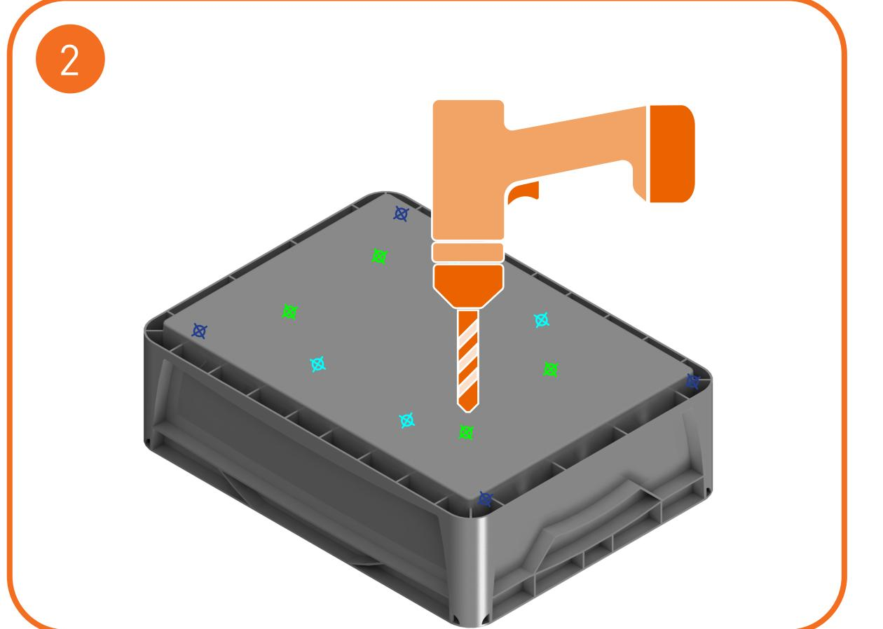
Bohren Sie anschließend mit einem passenden Bohrer Ø6 große Löcher in die markierten Stellen. Ⓛ
