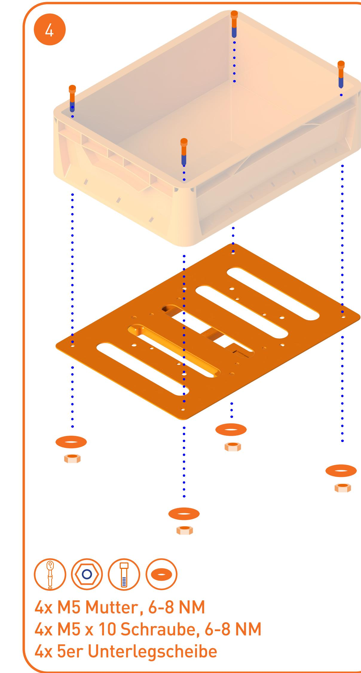
Das Zubehör kann mit den beigelegten M5x10 Schrauben, Unterlegscheiben und Muttern befestigt(6-8NM) werden.
