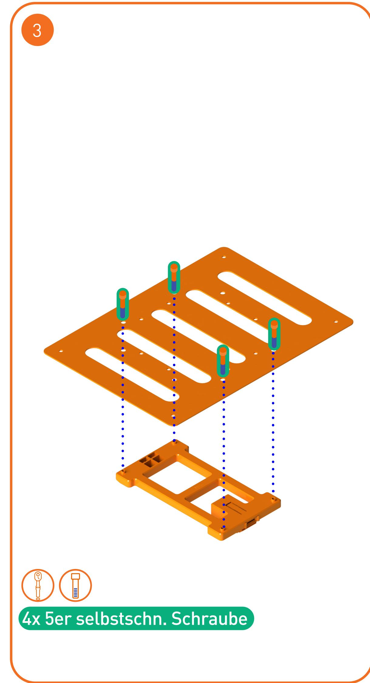
Die Montageplatte wird mit den **selbstschneidenden Schrauben** an dem MIK Adapter befestigt.
