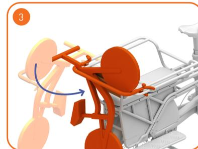
Schwenken Sie die Bicycle Hook mit dem eingehängten Kinderrad und fixieren die andere Seite der Bicycle Hook an der Ride Bar. Beachten Sie, dass die Klammern zwischen den Außen- und Innenstreben positioniert sind.
