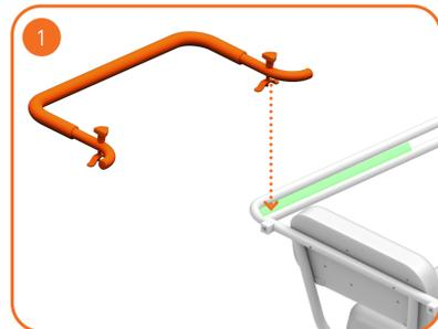
Positionieren Sie die vormontierte Bicycle Hook auf der Ride Bar. Achten Sie darauf, dass die Klammern **zwischen den Außen- und Innenstreben** positioniert sind.
