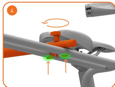
Fixieren Sie die Space-Bar indem Sie die beiden Knäufe im Uhrzeigersinn drehen. Achten Sie darauf, dass die Klammern sich gleichmäßig andrücken.
