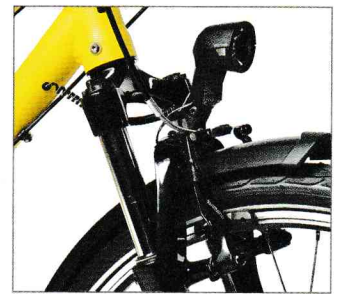
Es muss nicht immer Hydraulik sein: Die V-Bremsen ziehen klasse.
