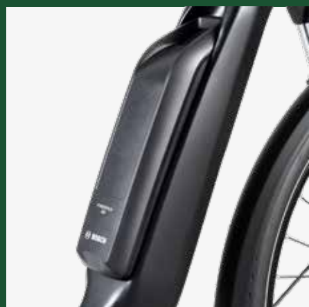
Conception fonctionnelle avec batterie semi-intégrée
