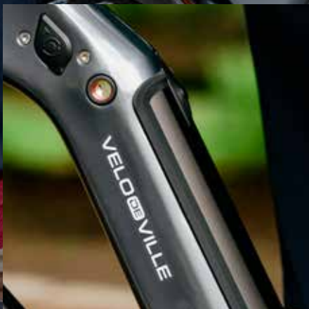
Batterie intégrée au cadre pour un look plus épuré et une plus grande capacité
