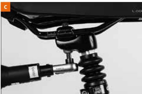
Una volta trovata la posizione desiderata verificate che le metà del meccanismo di bloccaggio aderiscano al telaietto della sella, prima di passare alla coppia di bloccaggio delle viti indicata dal produttore del reggisella.
