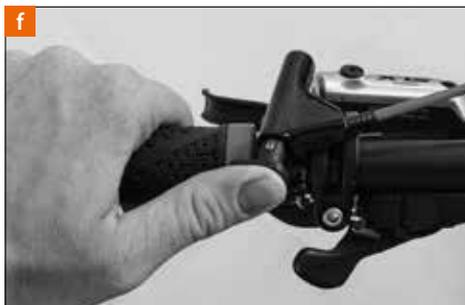
Un'ammortizzazione più debole fornisce una buona risposta ma in determinate circostanze come il superamento di ostacoli, per es. delle sporgenze, a velocità elevata, il carro posteriore si comprime con troppa forza o dondola pedalando in piedi. Un'ammortizzazione più forte indurisce la sospensione e limita il comfort di guida.
