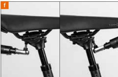
Serrate entrambe le viti uniformemente [f] per non modificare l'angolo della sella. Se desiderate spostare più in basso la punta della sella, serrate la vite anteriore in senso orario. Se necessario, allentate un poco la vite posteriore. Per spostare più in basso la parte posteriore, girare in senso orario la vite posteriore e se necessario allentare un poco quella anteriore.
