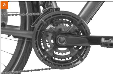
Il movimento centrale [a] funge da interfaccia tra pedivelle e telaio. Ci sono diverse tipologie: in alcuni casi l'asse fa parte del movimento centrale, in altri è integrato nella pedivella di destra. I cuscinetti a sfera impermeabili vengono forniti privi di gioco e non richiedono manutenzione. È necessario verificare regolarmente la sede stabile del movimento centrale nel telaio e delle pedivelle sul perno.
