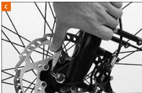
Nella posizione finale la leva deve essere perpendicolare all'asse del bloccaggio rapido; non deve assolutamente sporgere lateralmente. La leva deve aderire al telaio ovvero alla forcella in modo da non aprirsi involontariamente. Deve essere però anche facilmente accessibile in modo da poterla usare davvero rapidamente.
