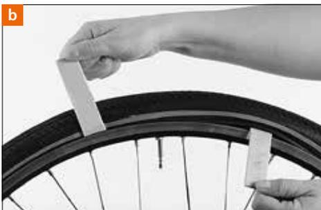
Appoggiate una leva di montaggio in plastica a circa 5 cm dalla valvola sul bordo inferiore dello pneumatico, sollevate il fianco del cerchio facendo leva sul bordo del cerchio [b]. Tenete la leva in questa posizione. Posizionate ora la seconda leva a circa 10 centimetri dalla prima leva, sull'altro lato della valvola, tra cerchio e pneumatico e, anche in questo caso, sollevate il fianco dello pneumatico facendo leva sul bordo del cerchio.
