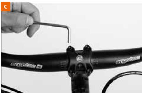
Per mettere a testa in giù l'attacco manubrio è inoltre necessario svitare le viti anteriori di fissaggio del manubrio [c]. Nel caso di attacchi manubrio con tappo è necessario semplicemente estrarre il manubrio. Altrimenti è necessario smontare le armature del manubrio.
