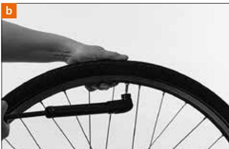
Premete leggermente la valvola verso la parte interna dello pneumatico affinché la camera d'aria non rimanga incastrata sotto lo pneumatico. Accertatevi che la valvola sia dritta. Se così non fosse smontate un fianco dello pneumatico e centrate nuovamente la camera d'aria.
