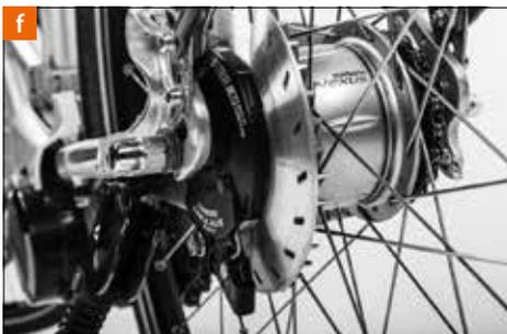
Un surriscaldamento eccessivo del mozzo può causare la perdita di lubrificante.
