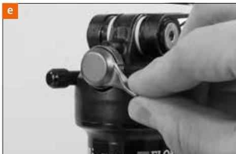
Inoltre in alcuni casi le sospensioni presentano uno **smorzamento in compressione** («compression») [d+e]. Il tipico smorzamento in compressione, o High Speed per alcune sospensioni, frena la compressione quando viene superato un ostacolo ad elevata velocità. In questi casi una compressione rapida potrebbe spaccare la sospensione.
