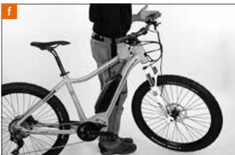
Per verificare la scorrevolezza della serie sterzo, sollevate con una mano il telaio in modo che la ruota anteriore non sia più a contatto con il suolo. La ruota anteriore deve oscillare da un estremo all'altro in maniera scorrevole e senza bloccarsi. Toccando leggermente il manubrio, la forcella deve spostarsi automaticamente dalla posizione centrale **[f]**.
