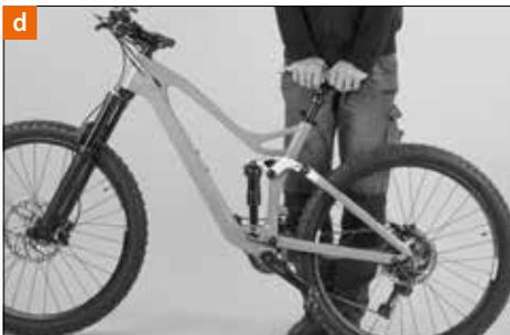
Quindi esercitate più volte pressione sul carro posteriore [d] ed eliminate il lubrificante in eccesso con un panno pulito prima dell'uscita successiva.
