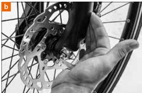
Spostare la leva verso la posizione di fissaggio, in modo che la scritta «Close» (chiuso) sia leggibile dal lato esterno. A partire dal movimento di chiusura fino alla metà del percorso, la leva deve muoversi facilmente.
