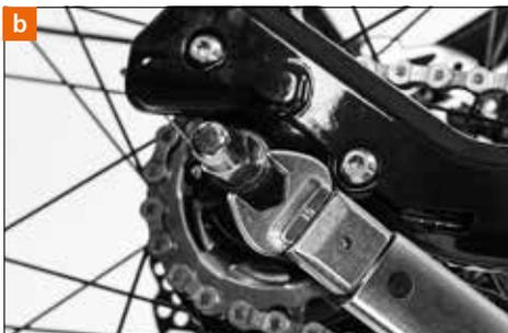
Portate il foro del braccio del freno a coincidere con il foro della fascetta del braccio del freno e inserite la vite di bloccaggio. Inserite da dietro un dado insieme a una rondella di spessore sul filetto della vite di bloccaggio. Avvitare l'uno dentro l'altro questi componenti per circa 3-4 giri.
