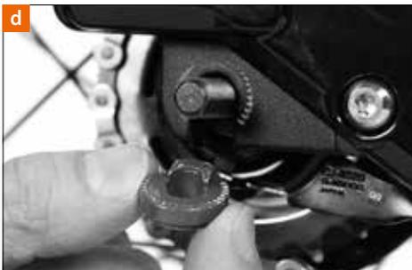
Tendete la catena e serrate i dadi dell'asse a 30-45 Nm [e] per fissare la ruota al telaio.
