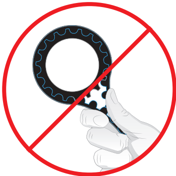
RIEM NIET GEBRUIKEN OM TANDWIELEN TE VERWIJDEREN
