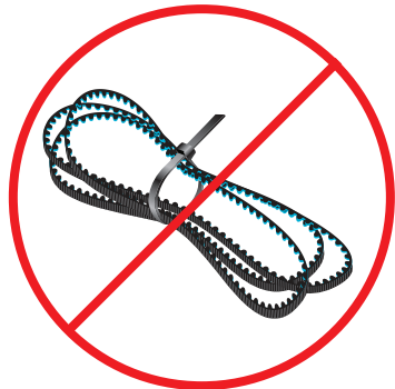
NIET SAMENBINDEN MET KABELBINDERS
