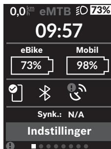
På statusskærmen får du ved siden af statuslinjen vist det aktuelle klokkeslæt, ladetilstanden for alle din eBikes akkuere og ladetilstanden for dit smartphone-batteri, hvis din smartphone er forbundet via Bluetooth®.
