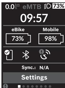
I statusskjermbildet vises statuslinjen, og i tillegg gjeldende klokkeslett, ladeneivået til alle batteriene til eBike og smarttelefonbatteriet hvis smarttelefonen er koblet til via Bluetooth®.
