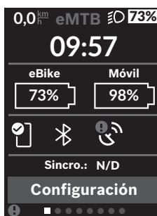
Además de la barra de estado, la pantalla de estado muestra la hora actual, el estado de carga de todos los acumuladores de su eBike y el estado de carga de la batería de su teléfono inteligente, en caso de que esté conectado a través de Bluetooth®.
