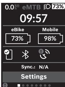
Στην οθόνη κατάστασης εμφανίζονται εκτός από τη γραμμή κατάστασης η τρέχουσα ώρα, η κατάσταση φόρτισης όλων των μπαταριών του eBike σας και η κατάσταση φόρτισης της μπαταρίας του smartphone σας, σε περίπτωση που το smartphone είναι συνδεδεμένο μέσω Bluetooth®.
