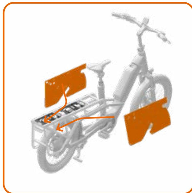
Die Wheel-Covers werden von vorne nach hinten zwischen Radschützer des Hinterrades und den Gepäckträgerstreben in die passende Position geschoben. Orientieren Sie sich dabei an den Löchern für die Befestigung in den Wheel Covers (siehe Grafik auf Seite 31).
