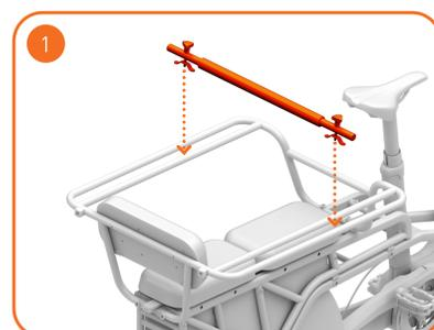
1 Positionieren Sie die vormontierte Space-Bar auf der Ride-Bar. Achten Sie darauf, dass die Klammern zwischen den Außen- und Innenstreben positioniert sind.
