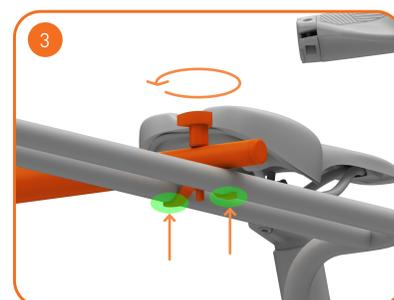
3 Fixieren Sie die Space-Bar indem Sie die beiden Knäufe im Uhrzeigersinn drehen. Achten Sie darauf, dass die Klammern sich gleichmäßig andrücken.
