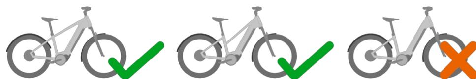
Per il SEB PRO HD-CARRIER sono ammesse solo le forme del telaio diamante e trapezio. La forma del telaio WAVE non è ammessa per il SEB PRO HD-CARRIER!
